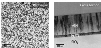
AlN: Ausgeprägte Fasertextur Säulen entlang <0001> mit ~50 nm Durchmesser und ~500 nm Länge
