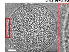
Kantenkontrast (→ Interferenzkontrast) im Phasenkontrast hebt die amorphe Struktur des Suprapartikel hervor.
